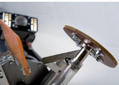
Mit den robusten und flexiblen Spachtelrobotern von KA-TE werden schadhaft Stellen und Anschlüsse in Kanälen DN 150 bis 800 dauerhaft repariert. Seit Einführung dieses innovativen Verfahrens von KA-TE wurden bisher mehr als 800.000 mängelfreie Reparaturen weltweit durchgeführt. Die ersten Reparaturen stellen heute, nach über 20 Jahren, noch kraftschlüssige und funktionstüchtige Verbindungen dar.
