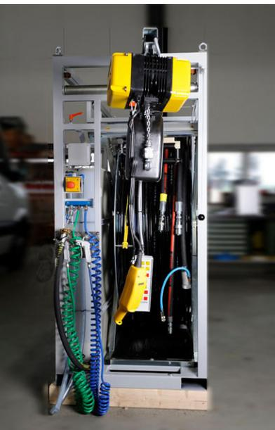
Mobil, flexibel und dennoch mit dem vollen Leistungsumfang der seit Jahren bewährten Robotersysteme von KA-TE: Dies alles bietet COMPACT von KA-TE, die mobile Multifunktionsanlage für Roboterarbeiten in der Kanalsanierung.
